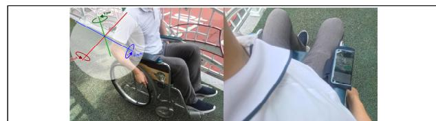
[그림 1] 스마트폰 설치 위치와 가속도 축
