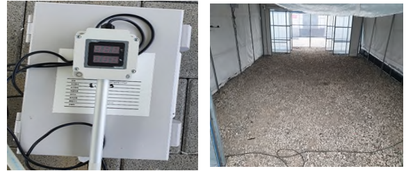
[그림 3] 온·습도 센서 노드 및 에어로젤이 설치된 시설하우스
