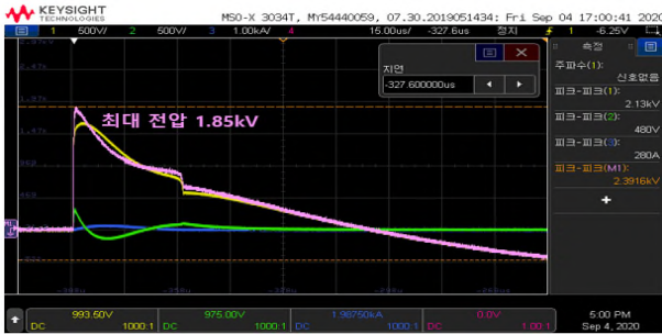
(a) 하드웨어 시험 결과(C3 : 5kV, 2.5kA, 50cm)
