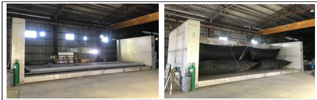
[그림 4] 직립형 고무보 기술(도복 및 기립시 작동)
