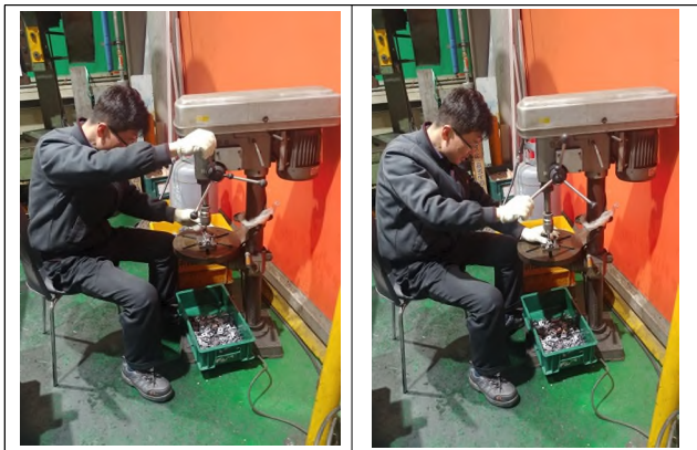
[그림 3] 기존 수작업에 의한 브라켓 나사산 작업 모습
