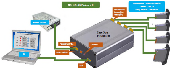
[그림 4] 헤드 온도 제어 System 구성
