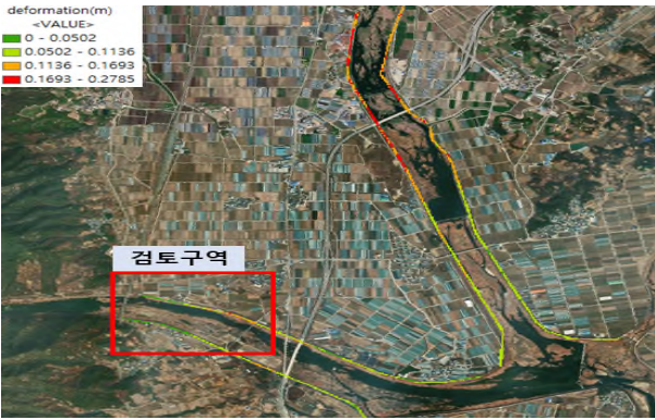
[그림 4] 금곡교 제방 변위량 산출결과
