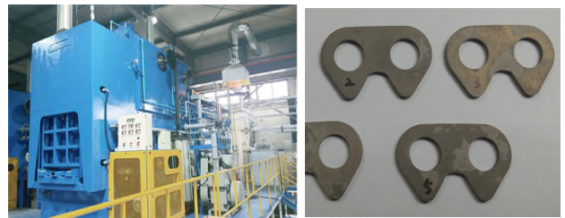
[그림 1] 가스 침유질화 열처리로 및 대상 부품(체인플레이트)
