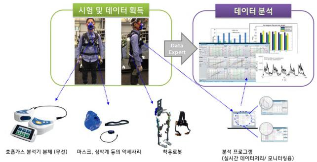
[그림 3] Metabolic cost 시험 구성<sup>[3]</sup>
