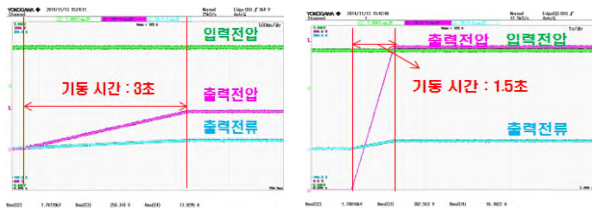
(a) 기동시간 3초 (b) 기동시간 1.5초 [그림 1] 정상기동시험 파형(단독운전-직류 1800[V])
