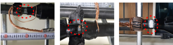
(a) 절연층 결함(25m) (b) 구리침 결함(50m) (c) 철가루 결함(77m) [그림 3] 케이블 시료 결함
