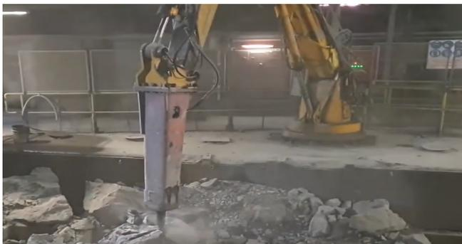
[그림 4] 로봇을 이용한 무인채광
