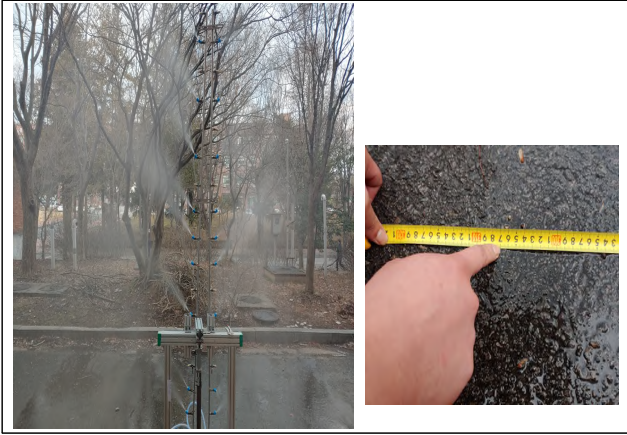
[그림 4] 펌프 분사거리 실험 사진
