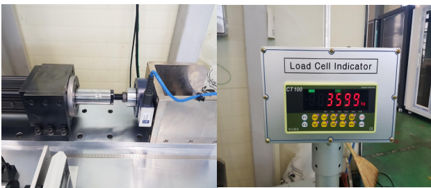
[그림 10] 모터병렬식 전동실린더의 최대추력 실험결과
