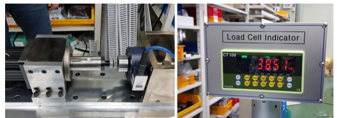
[그림 6] 모터직결식 전동실린더의 최대추력 실험결과
