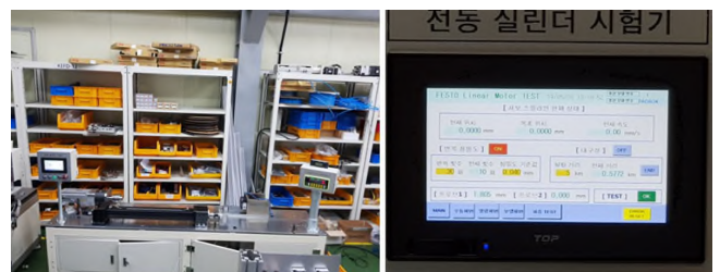
[그림 7] 모터직결식 전동실린더의 실험구성(반복위치정밀도)
