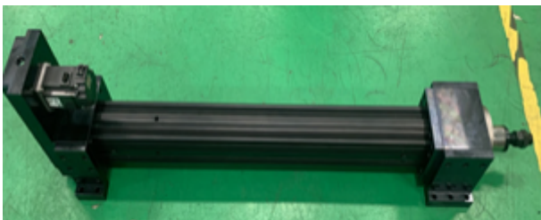
[그림 4] 모터병렬방식의 회전방지형 전동실린더
