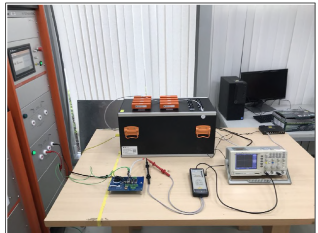
[그림 5] 임펄스 제한 전압 성능시험 사진
