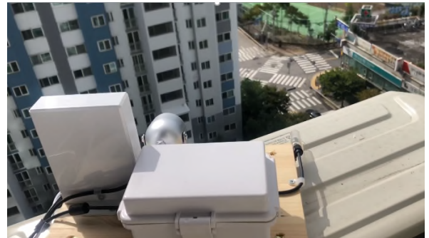
[그림 1] 개발된 IoT기반 다중센서 단말기 프로토타입
