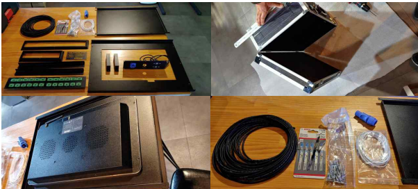
그림 572 시험·검증 플랫폼 부속품 제작상태 및 조립, 외함 가공
