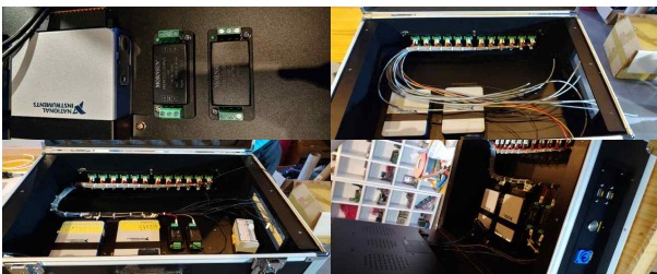
그림 573 시험·검증 플랫폼 주요 부속의 결합 및 결선, 터치컨트롤러 조립
