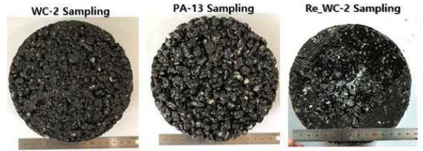
[그림 2] Asphalt Specimens
