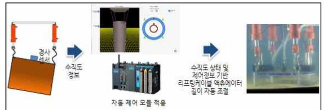
[그림 4] 수직도 제어정보시스템과 리프팅케이블 제어시스템 연계 자동화 모듈 개념도
