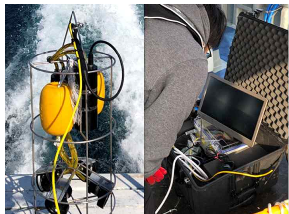
[그림 2] 성계 서식밀도 조사에 사용된 실시간 4ch Multi-CCTV
