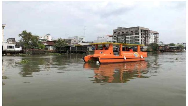
[그림 2] H기업의 태양광 부유 쓰레기 수거용 선박
