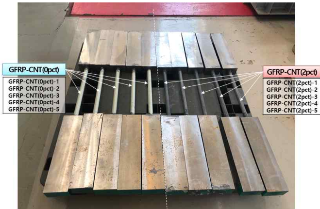
[그림 3] 그림부를 보강한 복합재 보강근
