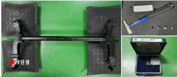
[그림 6] 모달시험 및 임팩트헤머, 가속도센서
