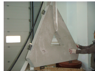
(d) assembling of concrete unit
