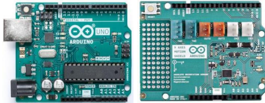
(a) Arduino Uno (b) 9Axes Motion Sensor
