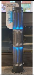
본 연구에서 개발된 청정공기 공급장치의 성능을 Table 3에 정리하였다. 청정공기 공급장치의 주요 기능인 미세먼지 저감 성능을 확인하기 위해 실내용 공기청정기의 시험방법(SPS-KACA 002-132:2018)을 활용하였다. 공인시험기관을 통해 객관적인 성능을 확인한 결과, 입자 저감효율은 90%, 청정화능력(CADR: Clean Air Delivery Rate)은 4.4 m<sup>3</sup>/min을 가진다.
