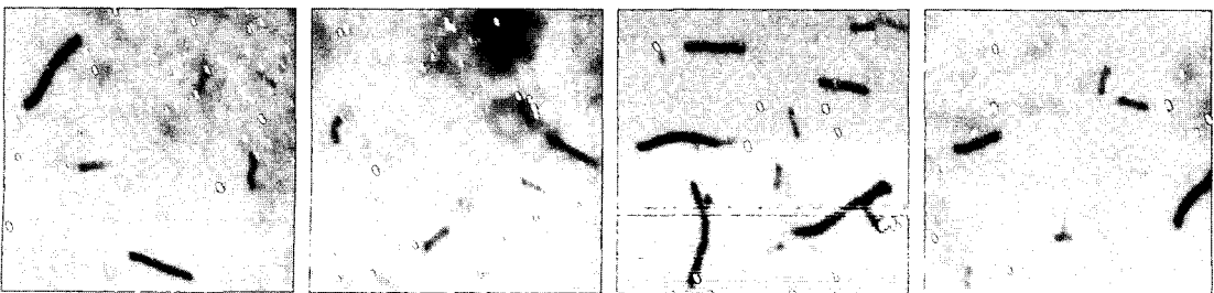
그림 2. 실리콘 웨이퍼 위에 탄소나노튜브를 분산시킨 시료로부터 얻은 EFM 위상 이미지
