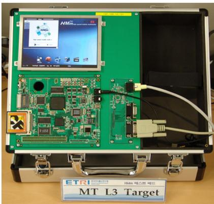
[그림 7] 개발된 L3 이동단말 플랫폼 모습
