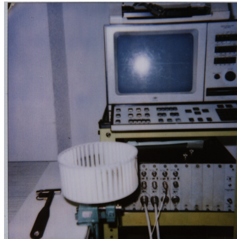
[그림 4] 충격 가진 실험 장치
