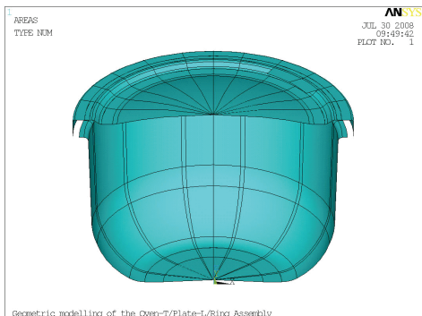
[그림 2] 전기보온압력밥솥 체결 구조물의 모델링
