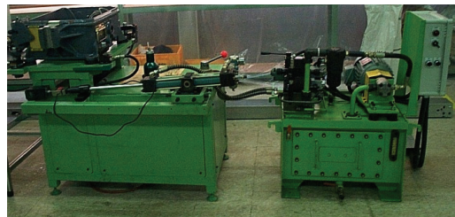
[그림 6] 시험장비에 전기선로전환기 설치[1]
