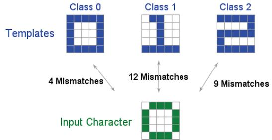
[그림 1] 해밍 거리를 이용한 원형 정합
