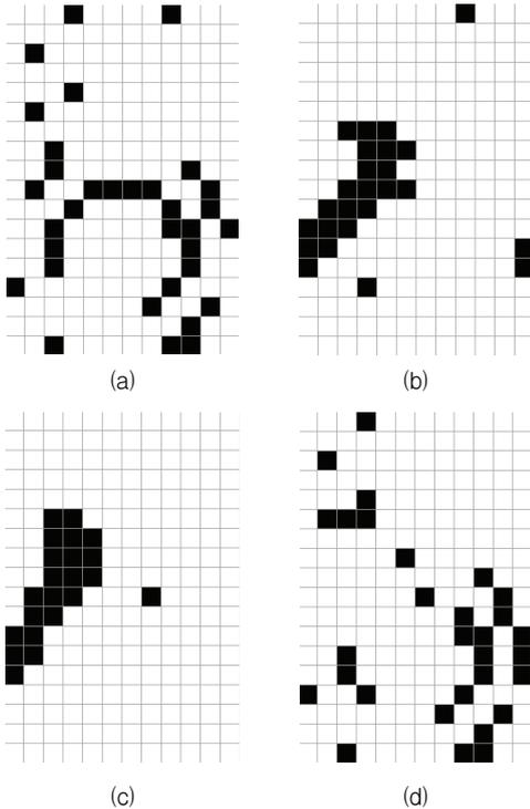
[그림 5] 해밍 거리: (a) 그림 4(c)의 ‘8’과 그림 4(a)의 ‘8’ 사이의 해밍 거리  $D_h = 33$ , (b) 그림 4(c)의 ‘8’과 그림 4(b)의 ‘3’사이의 해밍 거리  $D_h = 25$ , (c) 그림 4(d)의 ‘3’과 그림 4(a)의 ‘8’ 사이의 해밍 거리  $D_h = 22$ , (d) 그림 4(d)의 ‘3’과 그림 4(b)의 ‘3’사이의 해밍 거리  $D_h = 30$ .
