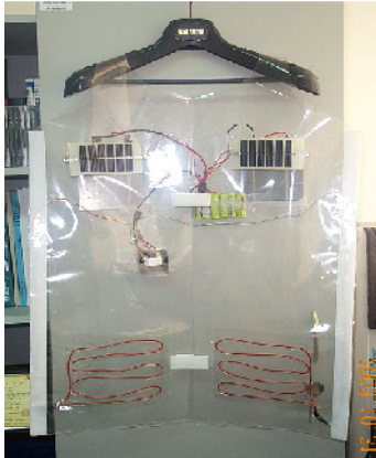
[그림 4] 솔라셀을 이용한 히터 재킷
