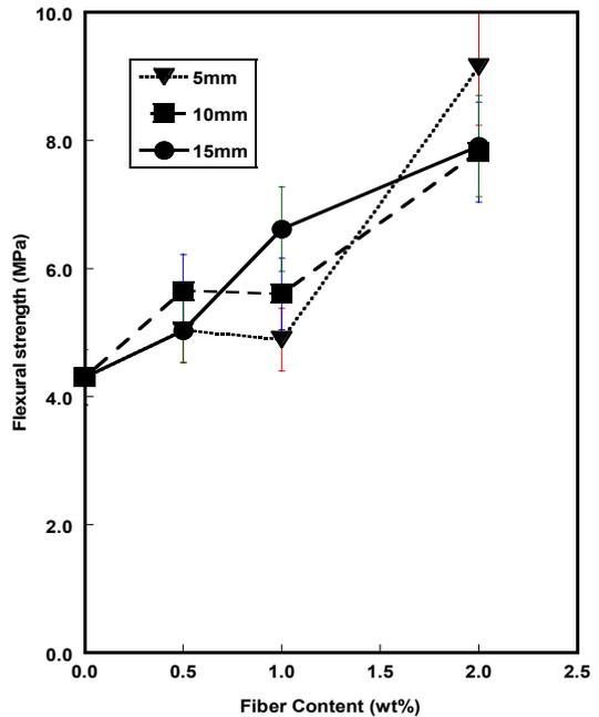
[그림 5] 섬유장 및 혼입률에 따른 현무암 단섬유 강화 시멘트 복합재료의 최대 굽힘강도.
