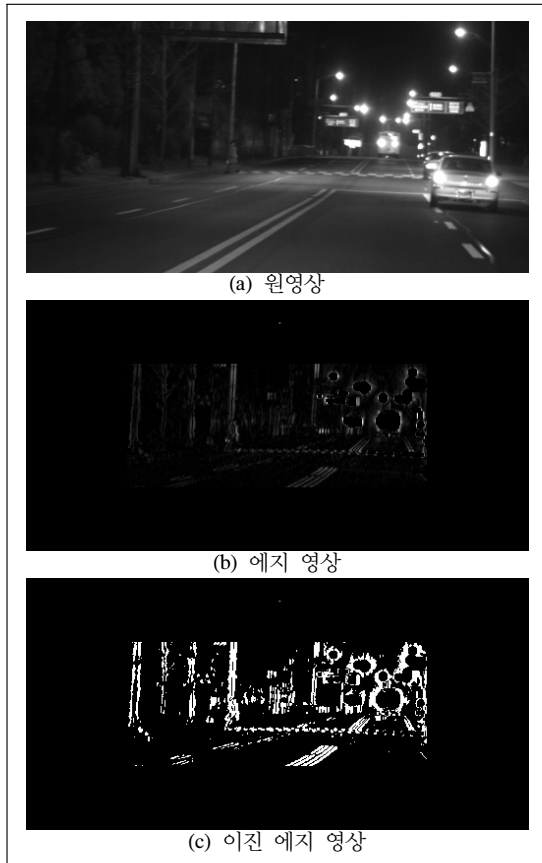
[그림 11] 보행자 에지 검출 실패 예. (보행자가 헤드라이트에서 비교적 먼 거리에 있고, 가로등 조명 바깥에 서있어서 배경과 밝기가 비슷해서 에지가 잘 검출되지 않았다.)
