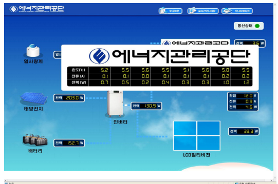
[그림 7] 모니터링 시스템의 구성 및 모니터링 화면
