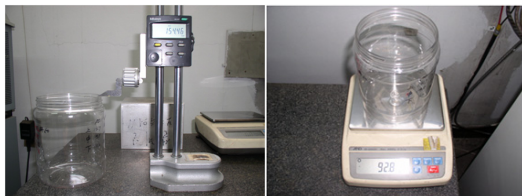
(a) 샘플링 제품 높이측정 (b) 샘플링 제품 중량측정 [그림 9] 샘플링 제품 측정결과
