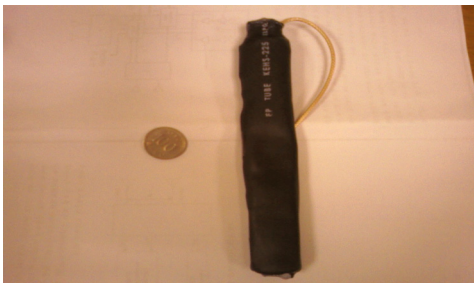
[그림 5] 소형 경량화된 저전력 무선 송출기 사진
