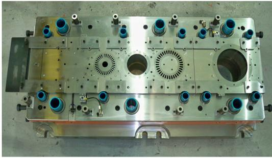
[그림 12] 실제 제작금형 하형 평면도
