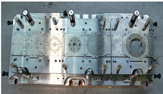
[그림 13] 실제 제작금형 상형 평면도
