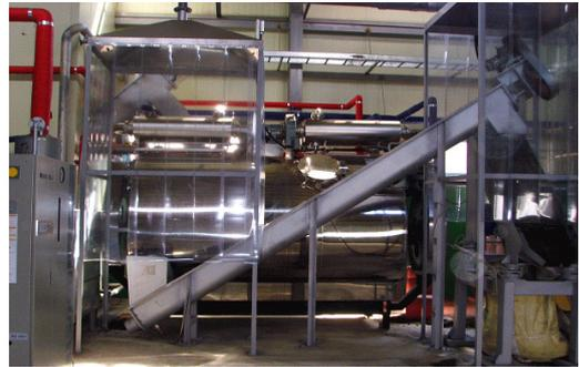
[그림 4] 고속건조기 설치 예(3ton/day)
