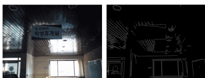
(a)원 영상 (b)Canny-Edge 검출기 [그림 2] 에지 성분 검출 영상
