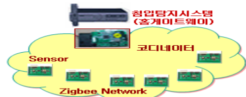
[그림 1] 코디네이터 기반 침입탐지시스템 구조
