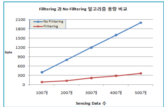
[그림 5] No Filtering과 Filtering 방식 용량 비교 분석
