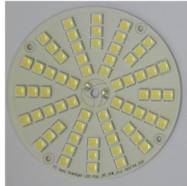
[그림 12] 10W LED 조명등을 위한 64개 LED MCPCB 시제품
