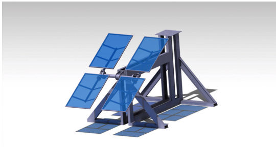
[그림 3] Catia 를 이용한 기구부 개념설계
