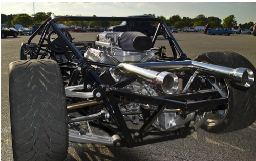
[그림 1] 경주용 자동차의 스페이스 프레임 사진
