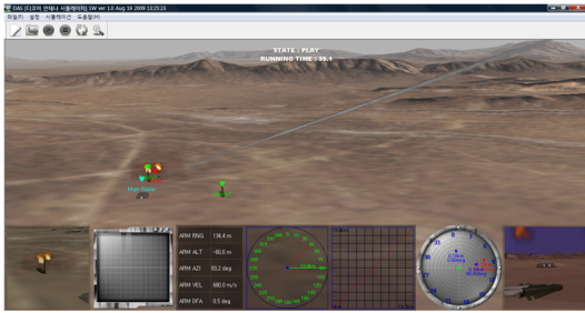
[그림 11] ARM이 한 쪽 디코이를 타격하는 경우(디코이 2개, ARM 수신기 방탐오차(±1°) 밖(D=250m)에 위치)
