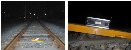
[그림 13] 틸팅시 발리스 응용시험
