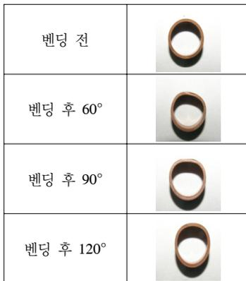
[그림 13] 각도에 따른 파이프 벤딩 후 절단면 사진 (9.5 mm)
