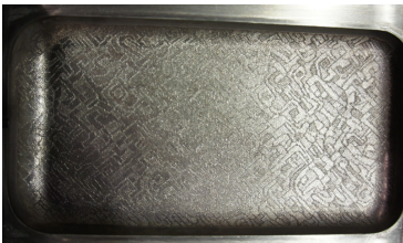
[그림 7] 프레스 가공에 의해 제작된 곡면 Ni stamper
