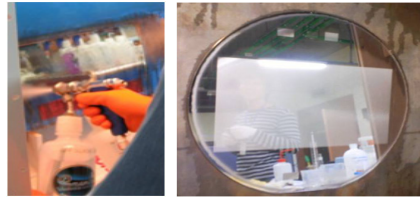
[그림 2] 스프레이법을 이용한 seed layer 형성
