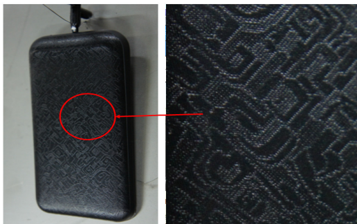
[그림 11] 3차원 표면 구조를 가지는 휴대폰 케이스
